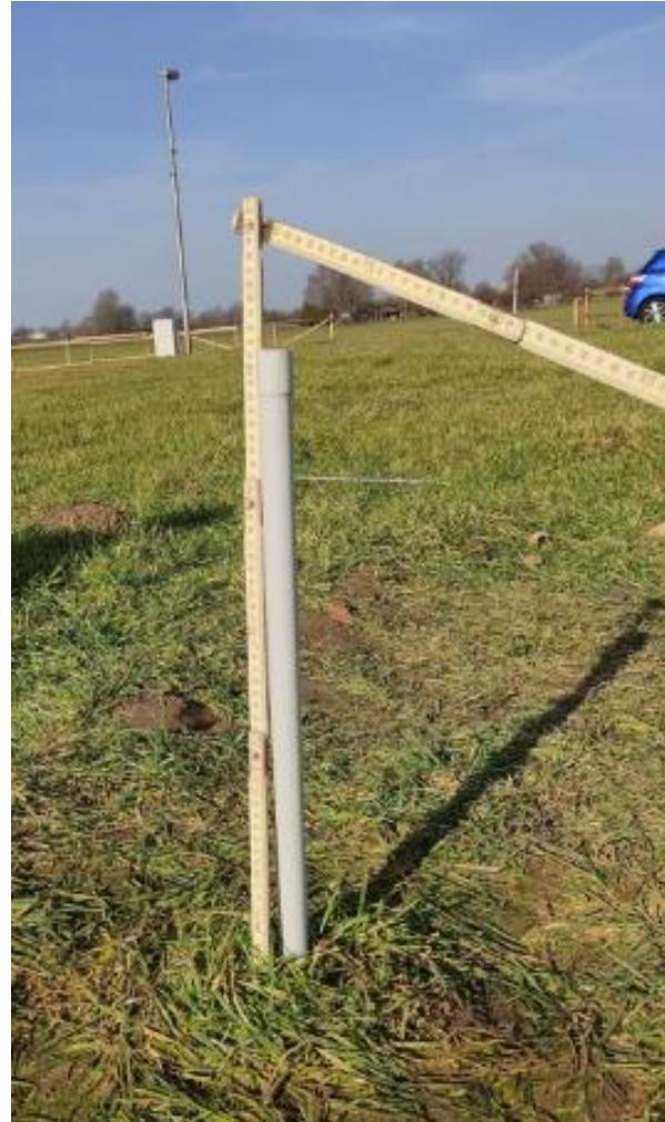
Versuchsanordnung Open-End-Test (instationär)
