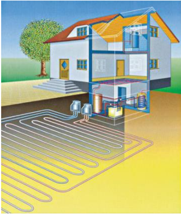
Rohrschleifen in 1 – 2 m Tiefe
